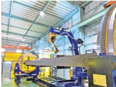
山口重工業関東工場（宇都宮市）で加工中の東京製鉄「ほぼゼロ」H形鋼。整備工場の大梁として使用される計画だ。
